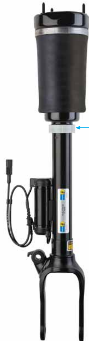
Иллюстрация 4. Некорректная установка! Мастер забыл удалить клипсу после монтажа.
