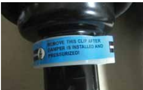
Иллюстрация 3. Наклейка на монтажной клипсе указывает на необходимость удалить ее после установки пневмомодуля и создания давления в системе.
