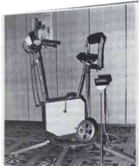
Самодельное кресло «Волчок» для тренировки вестибулярного аппарата в быту, сконструированное В.Алексеевым из двух велосипедов.
