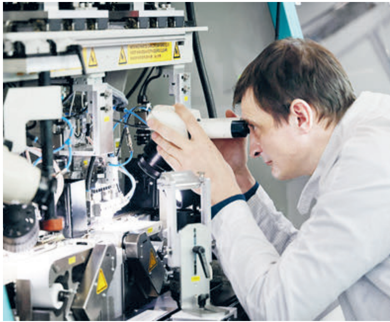
Зеленоград. Герметизация чип-слотов на участке сборки чип-модулей завода «Микрон».
