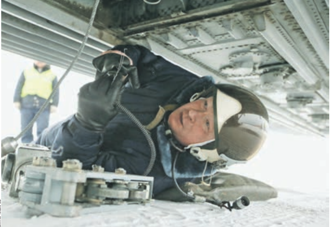
Вчера 11:10 Бортовой оператор Сергей Игнатьев цепляет к брюху пожарного вертолета Ми-26 рост от специального сливного устройства, в которое может поместиться до 15 тонн воды
