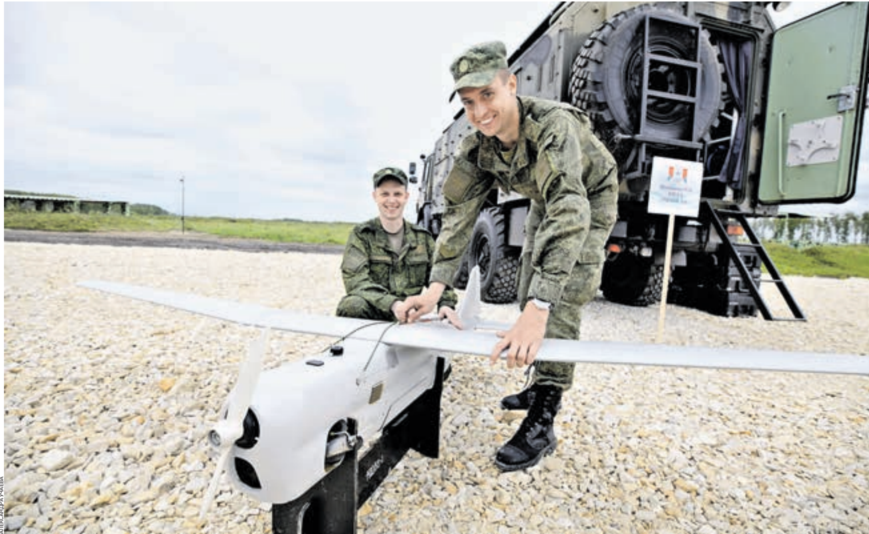
Вчера в 13:40 рядовой Иван Хохлев (справа) и лейтенант Константин Банин запускают военный беспилотный аппарат «Орлан-10» во время соревнований военных беспилотников в Коломне. Дальность действия комплекса БПЛА «Орлан-10» составляет до 130 километров, продолжительность полета — более 10 часов
