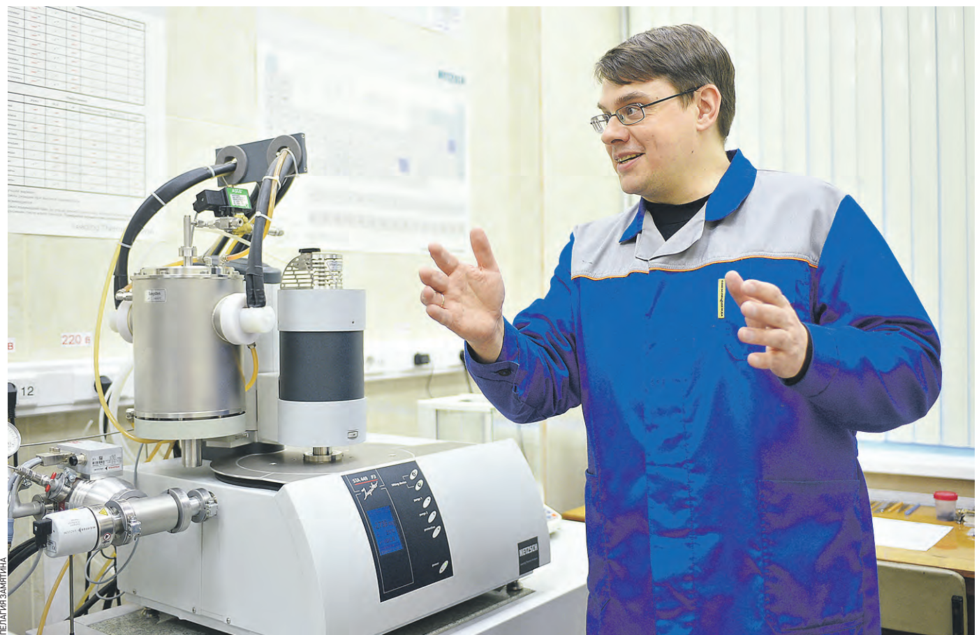
Вчера 17:12 Доцент МАИ Алексей Астапов показывает синхронный термический анализатор — прибор, который анализирует изменение структуры материала в процессе нагрева или охлаждения в различных средах
