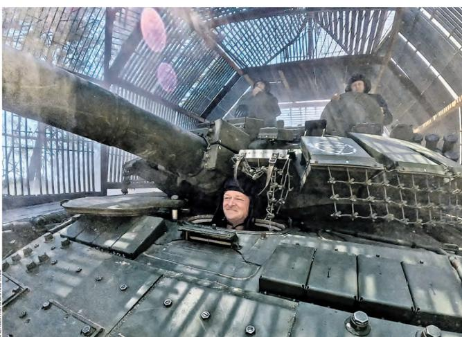
21 июня. Военнослужащие группировки войск «Днепр» во время работы экипажа танка Т-72БМ с комплексом активной защиты (КАЗ) типа «Дикобраз» от FPV-дронов в Херсонской области. Металлические сетчатые конструкции, расположенные вокруг боевой машины, защищают солдат и технику от беспилотников противника. А еще в передней части танка размещено оборудование разминирования для преодоления минных заграждений.
